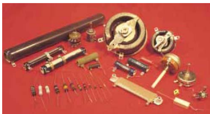
FIGURA 8 Um sortimento de resistores utilizados em circuitos elétricos.
