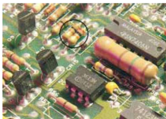
FIGURA 9 As faixas coloridas de um resistor representam um código para determinar sua resistência. As duas primeiras cores fornecem os dois primeiros dígitos no valor da resistência. A terceira cor representa a potência de dez multiplicadora do valor da resistência. A última cor é a tolerância do valor da resistência.
